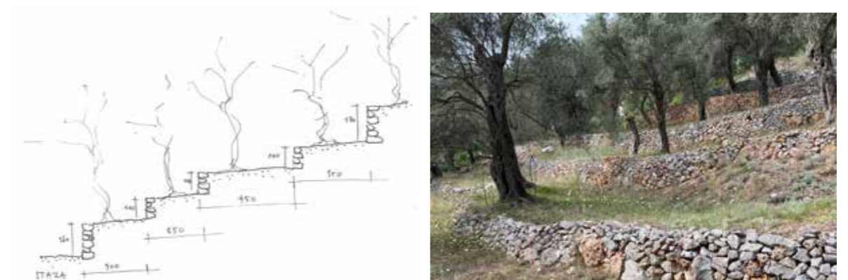
Poprečni presjek i fotografija terasa u zoni iznad puta sa strane planine/ Ana e malit
