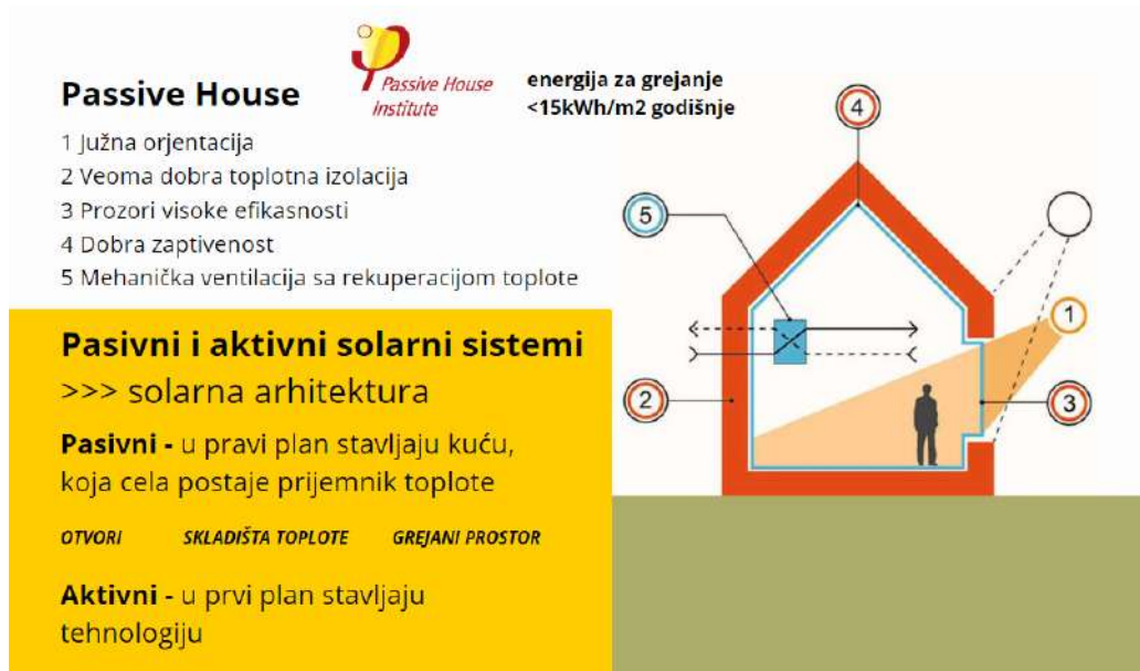
Slika 16: Osnovnih 5 principa pasivne kuće po Passive House Institute
